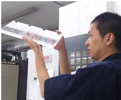
アクリルの削り具合を確認する技師
